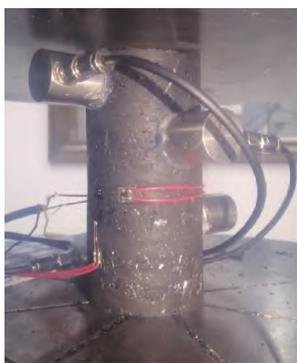
图 9 煤样声发射传感器布设方式
