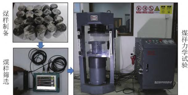
图 8 压力试验机系统及其试验流程
